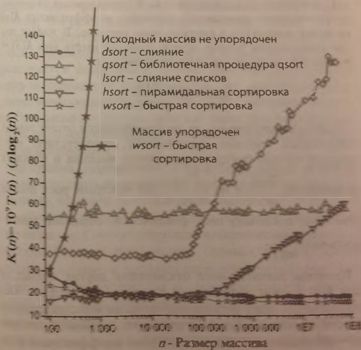
Рис. 29. Сортировки массивов на Pentium IV, 2.4 GHz, 2 GByte ОО
