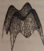
Рис. 96. Сжатие редукцией, ошибка аппроксимации 0,1%
