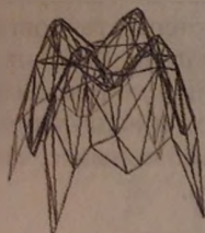
Рис. 95. Сжатие редукцией, ошибка аппроксимации 2%
