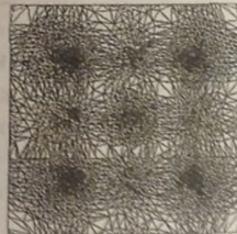
Рис. 97. Сжатие редукцией на трех процессорах, ошибка аппроксимации 0,1%
